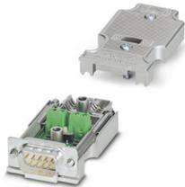
Connettore D-SUB, 9 poli, maschio, versione assiale con due ingressi cavi, per sistema bus: PROFIBUS DP fino a 12 MBit/s, resistenza terminale inseribile tramite interruttore a scorrimento, piedinatura: 3, 5, 6, 8; morsetti a vite
