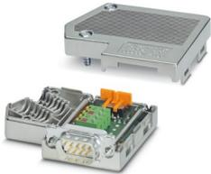
Connettore D-SUB, a 9 poli, maschio, due ingressi cavi a 35°, sistema bus: PROFIBUS DP fino a 12 MBit/s, resistenza terminale inseribile mediante interruttore a scorrimento, piedinatura: 3, 5, 6, 8; morsetti a molla
