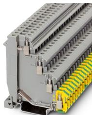
Morsetto iniziatore/attuatore, tensione nominale: 250 V, corrente nominale: 24 A, tipo di connessione: Connessione a vite, 1., 2., 3. e 4. piano, Sezione di dimensionamento: 2,5 mm<sup>2</sup>, sezione: 0,2 mm<sup>2</sup> - 4 mm<sup>2</sup>, tipo di montaggio: NS 35/7,5, NS 35/15, colore: grigio
