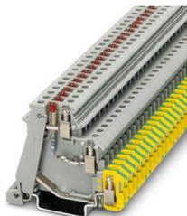
Morsetto iniziatore/attuatore, tensione nominale: 24 V, corrente nominale: 24 A, tipo di connessione: Connessione a vite, Sezione di dimensionamento: 2,5 mm<sup>2</sup>, sezione: 0,2 mm<sup>2</sup> - 4 mm<sup>2</sup>, tipo di montaggio: NS 35/7,5, NS 35/15, colore: grigio
