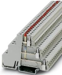
Morsetto iniziatore/attuatore, tensione nominale: 250 V, corrente nominale: 24 A, tipo di connessione: Connessione a vite, 1., 2. e 3. piano, Sezione di dimensionamento: 2,5 mm<sup>2</sup>, sezione: 0,2 mm<sup>2</sup> - 4 mm<sup>2</sup>, tipo di montaggio: NS 35/7,5, NS 35/15, colore: grigio
