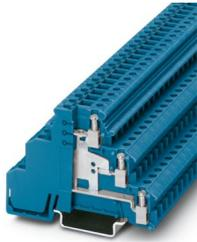
Morsetto iniziatore/attuatore, con ripartitore di potenziale, tensione nominale: 250 V, corrente nominale: 24 A, tipo di connessione: Connessione a vite, 1., 2. e 3. piano, Sezione di dimensionamento: 2,5 mm<sup>2</sup>, sezione: 0,2 mm<sup>2</sup> - 4 mm<sup>2</sup>, tipo di montaggio: NS 35/7,5, NS 35/15, colore: blu
