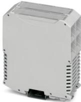
Custodie per guide DIN, Custodia completa con piedino di fissaggio in metallo, design alto, con feritoie di ventilazione, larghezza: 45,2 mm, altezza: 99 mm, profondità: 113,65 mm, colore: grigio chiaro (simili RAL 7035), collegamento trasversale: Connettore per guide di supporto (opzionale), n. poli connettore trasversale: 5
