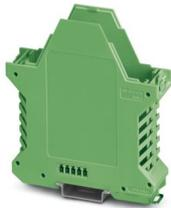
Custodie per guide DIN, Base custodia con piedino di fissaggio in metallo, design alto, con feritoie di ventilazione, larghezza: 22,6 mm, altezza: 99 mm, profondità: 107,3 mm, colore: verde (simili RAL 6021), collegamento trasversale: connettore bus integrato, n. poli connettore trasversale: 5, Connettore bus: 5 contatti paralleli
