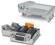
Connettore D-SUB, connettore femmina a 9 poli, due uscite cavo a 35° su due file di morsetti, sistema bus: CAN, CANopen®, SafetyBus-P fino a 1 MBit/s, resistenza di terminazione attivabile tramite interruttore a scorrimento, piedinatura: 2, 3, 7, 9; morsetti a vite
