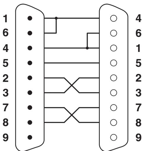
Schema di collegamento PSM-AD-D9-NULLMODEM
