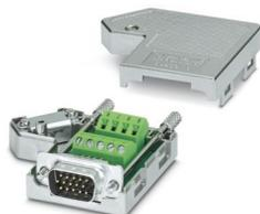
Connettore D-SUB, 15 poli HD (High Density), spina, un'uscita cavo a 35°, tipo universale per tutti i sistemi, piedinatura: 1, 2, 3, 6, 7, 8, 10, 13, 14 su morsetto a vite
