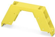
Custodie per guide DIN, Parte superiore della custodia per morsetti per circuiti stampati con connessione a vite, larghezza: 17,6 mm, altezza: 99 mm, profondità: 45,85 mm, colore: giallo (simili RAL 1018)
