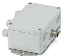
Convertitore IO-Link/analogico Axioline E con 4 ingressi TC analogici (tipo K/J), tecnologia di connessione a 2 conduttori, 1 porta A IO-Link, 24 V DC, grado di protezione IP65
