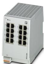
Managed Switch 2000 serie, 16 Porte RJ45 10/100/1000 MBit/s, PROFINET Conformance-Class A, Processo di sviluppo certificato secondo la norma IEC 62443-4-1, Compatibile con la norma IEC 62443-4-2
