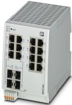
Managed Switch 2000 serie, 12 Porte RJ45 10/100 MBit/s, 2 Porte SFP 100 MBit/s, 2 Porte Combo 10/100 MBit/s, PROFINET Conformance-Class B, Campo di temperatura esteso, Processo di sviluppo certificato secondo la norma IEC 62443-4-1, Compatibile con la norma IEC 62443-4-2
