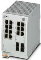
Managed Switch 2000 serie, 14 Porte RJ45 10/100 MBit/s, 2 SC-Singlemode 100 MBit/s, PROFINET Conformance-Class B, Campo di temperatura esteso, Processo di sviluppo certificato secondo la norma IEC 62443-4-1, Compatibile con la norma IEC 62443-4-2
