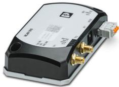
WLAN Access Point, client con 2 collegamenti per antenne esterni (RSMA-F), IP20, campo di temperatura: 0 °C ... +60 °C, WLAN 802.11 a, b, g, n, frequenza: 2,4 GHz, 5 GHz, collegamenti: COMBICON 9 V DC ... 32 V DC, RJ45: per LAN, Web, http/https, CLI, REST-API
