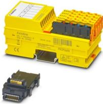
Axioline F, Modulo relè, Sicurezza funzionale, PROFIsafe, esclusivamente per il collegamento a controllori Phoenix Contact o Siemens, Ingressi di segnalazione: 2, Uscite OUT24V\_0 e OUT24V\_1: 2, Uscite di relè sicure: 4 (a potenziale zero), Contatto in chiusura, grado di protezione: IP20
