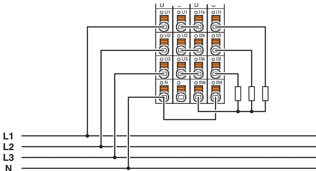
Connessione di un'utenza trifase per la misura della potenza in collegamento a stella con la corrente del conduttore di neutro
