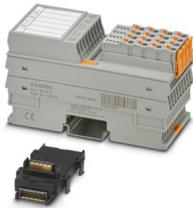
Axioline F, modulo di misurazione potenza, ingresso di tensione: fino a 400 V AC (fase/connettore di neutro) o 690 V AC (fase/fase), ingresso di corrente: fino a 5 A AC, velocità di trasmissione nel bus locale: 100 MBit/s, grado di protezione: IP20, incluso modulo di base bus e connettori Axioline F
