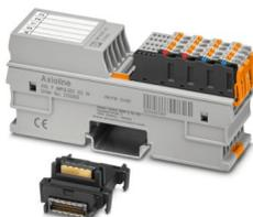
Axioline F XC, modulo funzionale, 2 interfacce a impulsi digitali per la valutazione del misuratore di percorso magnetostriativo con interfaccia start/stop, velocità di trasmissione nel bus locale di 100 MBit/s, grado di protezione IP20, incluso modulo di base bus e connettori Axioline F
