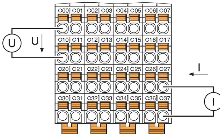
Connessione per misurazione di tensione e di corrente
