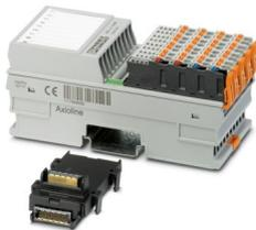
Axioline F, Modulo di ingresso analogico, Ingressi analogici: 8, 0 V ... 5 V, -5 V ... 5 V, 0 V ... 10 V, -10 V ... 10 V, 0 mA ... 20 mA, 4 mA ... 20 mA, -20 mA ... 20 mA, tecnica di connessione: 2 conduttori, velocità di trasmissione nel bus locale: 100 MBit/s, per applicazioni SAFE AI con funzionamento continuo senza assistenza, grado di protezione: IP20, incluso modulo di base bus e connettori Axioline F
