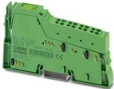
Inline, Modulo di rilevamento della temperatura, Ingressi UTH analogici: 4 (Tipo J), tecnica di connessione: 2 conduttori, velocità di trasmissione nel bus locale: 500 kBit/s, grado di protezione: IP20, Connettori Inline compresi
