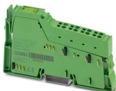
Inline, Morsetto ingresso analogico, Ingressi analogici: 4, 0 V ... 10 V, tecnica di connessione: 2 conduttori, velocità di trasmissione nel bus locale: 500 kBit/s, grado di protezione: IP20, Connettori Inline compresi
