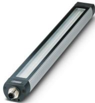
Illuminazione macchine a LED, 24 V DC, angolo di diffusione (verticale/orizzontale): 85 °/95 °, lunghezza: 365 mm, dimensioni: 40 mm, grado di protezione: IP67, orientabile, Resistente a lubrificanti e refrigeranti
