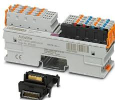
Axioline F, Modulo di ingresso/uscita digitale, Ingressi digitali: 16, 24 V DC, tecnica di connessione: 1 conduttore, Uscite digitali: 8, 24 V DC, 2 A, tecnica di connessione: 2 conduttori, velocità di trasmissione nel bus locale: 100 MBit/s, grado di protezione: IP20, incluso modulo di base bus e connettori Axioline F
