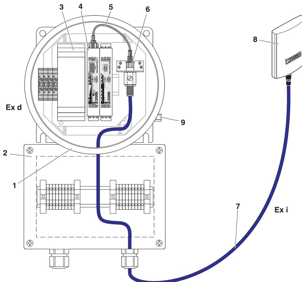
Installazione in una custodia del tipo di protezione ammessa "Incapsulamento resistente alla pressione" (EN 60079-1)
