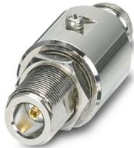
Barriera antenna per passacavo per quadro elettrico, tipo di protezione: Ex i, grado di protezione: IP65, installazione barriera: zone 2 / 22, installazione antenna: zona Ex gas e polveri, campo di frequenza: 0,3 GHz ... 6 GHz, connessione: 2 x N (femmina), omologazione ATEX-, IECEx
