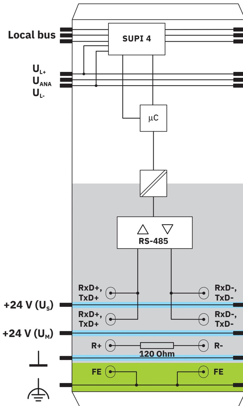
Circuito interno dei punti di connessione
