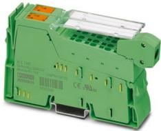
Inline, Morsetto funzionale, Ingresso contatore per segnali da 24 V: 1, Ingresso di controllo per segnali da 24 V: 1, Uscita di commutazione: 1, 24 V DC, 0,5 A, Variante per condizioni estreme:, velocità di trasmissione nel bus locale: 500 kBit/s, grado di protezione: IP20, connettori Inline e cartellini di siglatura incl.
