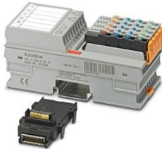
Axioline F, Modulo di uscita digitale, Uscite digitali: 4 (Uscite Triac con interruttore di minima tensione), 230 V AC, 2 A, tecnica di connessione: 3 conduttori, velocità di trasmissione nel bus locale: 100 MBit/s, grado di protezione: IP20, incluso modulo di base bus e connettori Axioline F
