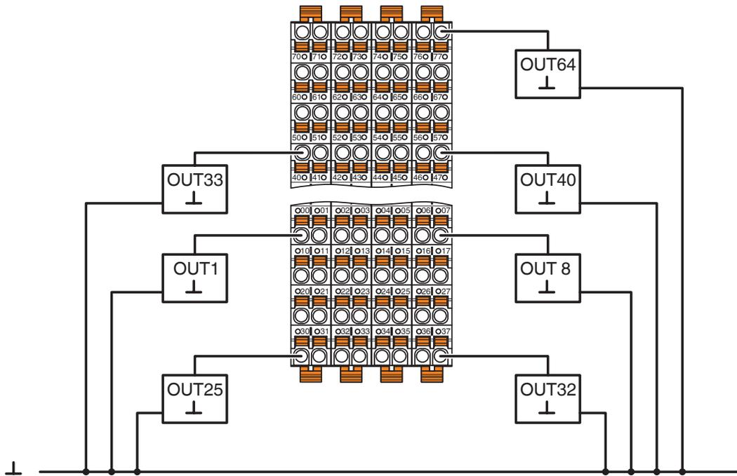
Collegamento con connessione a 1 conduttori
