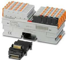
Axioline F, Modulo di uscita digitale, Uscite digitali: 64, 24 V DC, 500 mA, tecnica di connessione: 1 conduttore, velocità di trasmissione nel bus locale: 100 MBit/s, grado di protezione: IP20, incluso modulo di base bus e connettori Axioline F
