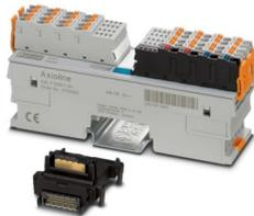
Axioline F, Modulo di ingresso digitale, Ingressi digitali: 32, 24 V DC, tecnica di connessione: 1 conduttore, velocità di trasmissione nel bus locale: 100 MBit/s, grado di protezione: IP20, incluso modulo di base bus e connettori Axioline F
