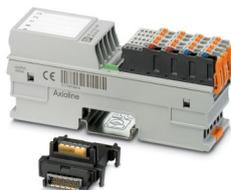
Axioline F, Modulo di ingresso analogico, Ingressi analogici: 4, 0 V ... 5 V, -5 V ... 5 V, 0 V ... 10 V, -10 V ... 10 V, tecnica di connessione: 2, 3, 4 conduttori, velocità di trasmissione nel bus locale: 100 MBit/s, alimentazione sensori integrata, Variante per condizioni estreme:, grado di protezione: IP20, incluso modulo di base bus e connettori Axioline F
