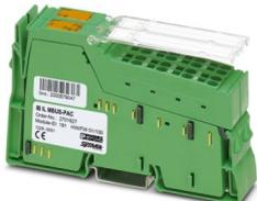
Inline, Master M-Bus, interfaccia M-Bus, per la connessione di dispositivi bus M, velocità di trasmissione nel bus locale: 500 kBit/s, grado di protezione: IP20, connettori Inline e cartellini di siglatura incl.
