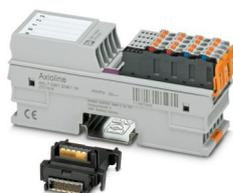
Axioline F, Modulo di ingresso/uscita digitale, Ingressi digitali: 8, 24 V DC, tecnica di connessione: 1 conduttore, Uscite digitali: 8, 24 V DC, 500 mA, tecnica di connessione: 1 conduttore, velocità di trasmissione nel bus locale: 100 MBit/s, grado di protezione: IP20, incluso modulo di base bus e connettori Axioline F
