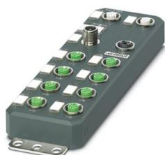
Axioline E, EtherCAT®, Connettore M12, porte IO-Link Class A: 4, tipo di connessione: Connettore M12, tecnica di connessione: 3 conduttori, porte IO-Link Class B: 4, tipo di connessione: Connettore M12, tecnica di connessione: 3 conduttori, Ingressi digitali su pin 2 per porte di classe A: 4, 24 V DC, tecnica di connessione: 3 conduttori, Custodia in plastica, grado di protezione: IP65/IP67
