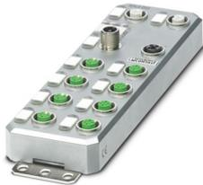
Axioline E, PROFINET, Connettore M12, porte IO-Link Class A: 4, tipo di connessione: Connettore M12, tecnica di connessione: 3 conduttori, porte IO-Link Class B: 4, tipo di connessione: Connettore M12, tecnica di connessione: 3 conduttori, Ingressi digitali su pin 2 per porte di classe A: 4, 24 V DC, tecnica di connessione: 3 conduttori, Custodia metallica, grado di protezione: IP65/IP67
