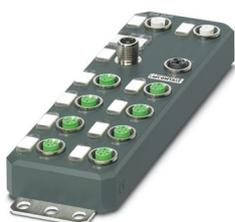
Axioline E, Dispositivo di ingresso/uscita digitale, PROFINET, Connettore M12, Ingressi digitali: 8, 24 V DC, tecnica di connessione: 4 conduttori, Uscite digitali: 8, 24 V DC, tecnica di connessione: 3 conduttori, Custodia in plastica, grado di protezione: IP65/IP67
