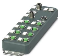
Axioline E, PROFIBUS DP, Connettore M12, porte IO-Link Class A: 4, tipo di connessione: Connettore M12, tecnica di connessione: 3 conduttori, porte IO-Link Class B: 4, tipo di connessione: Connettore M12, tecnica di connessione: 3 conduttori, Ingressi digitali su pin 2 per porte di classe A: 4, 24 V DC, tecnica di connessione: 3 conduttori, Custodia in plastica, grado di protezione: IP65/IP67
