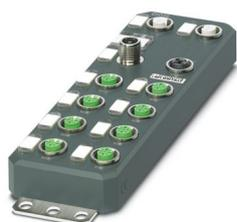
Axioline E, Dispositivo di ingresso/uscita digitale, EtherNet/IP™, Connettore M12, Ingressi digitali: 16, 24 V DC, tecnica di connessione: 4 conduttori, Uscite digitali: 16, 24 V DC, tecnica di connessione: 3 conduttori, Custodia in plastica, grado di protezione: IP65/IP67
