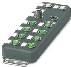
Axioline E, Dispositivo di ingresso/uscita digitale, EtherNet/IP™, Connettore M12, Ingressi digitali: 8, 24 V DC, tecnica di connessione: 4 conduttori, Uscite digitali: 8, 24 V DC, tecnica di connessione: 3 conduttori, Custodia in plastica, grado di protezione: IP65/IP67
