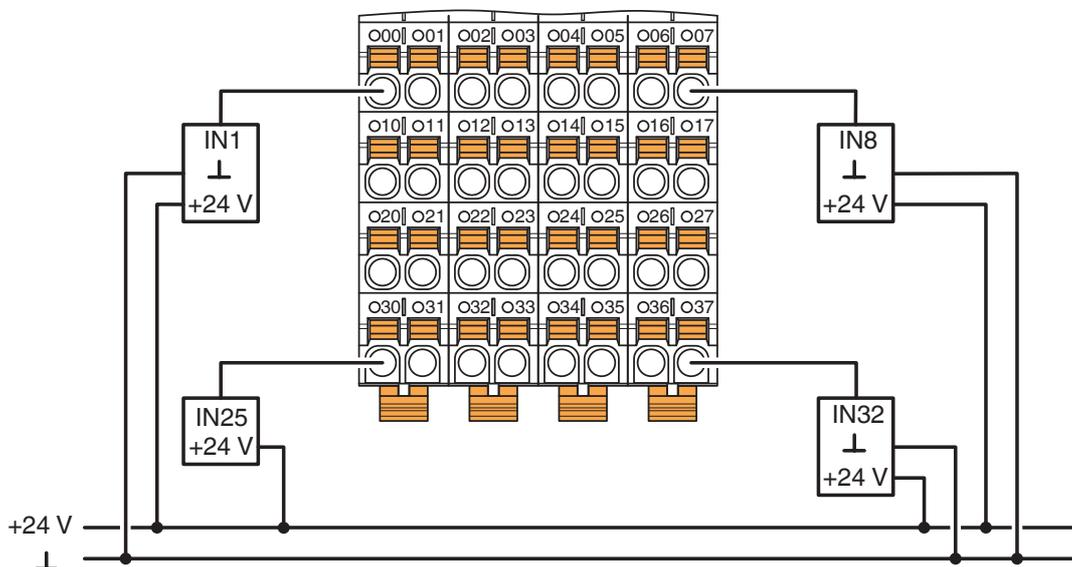
Collegamento con connessione a 1 conduttori
