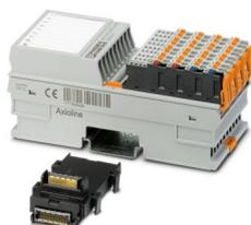
Axioline F, Modulo funzionale, Ingressi conteggio: 2, Ingresso encoder incrementale: 2, Encoder simmetrici secondo EIA-422 ed encoder asimmetrici, Ingressi digitali: 8, 24 V DC, Uscite digitali: 2, 24 V DC, Variante per condizioni estreme:, velocità di trasmissione nel bus locale: 100 MBit/s, grado di protezione: IP20, incluso modulo di base bus e connettori Axioline F
