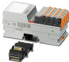
Axioline F, Modulo di uscita digitale, Uscite digitali: 32, 24 V DC, 500 mA, tecnica di connessione: 1 conduttore, Variante per condizioni estreme:, velocità di trasmissione nel bus locale: 100 MBit/s, grado di protezione: IP20, incluso modulo di base bus e connettori Axioline F
