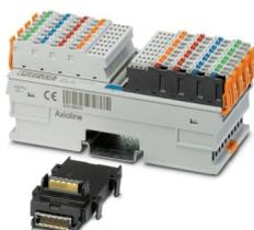
Axioline F, Modulo di ingresso digitale, Ingressi digitali: 16, 24 V DC, tecnica di connessione: 4 conduttori, Variante per condizioni estreme:, velocità di trasmissione nel bus locale: 100 MBit/s, grado di protezione: IP20, incluso modulo di base bus e connettori Axioline F
