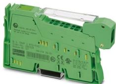
Inline, Modulo di rilevamento della temperatura, Ingressi RTD analogici: 2, tecnica di connessione: 2, 3, 4 conduttori, velocità di trasmissione nel bus locale: 500 kBit/s, Variante per condizioni estreme:, grado di protezione: IP20, connettore Inline e cartellini di siglatura incl.
