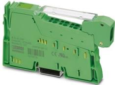
Inline, Morsetto ingresso analogico, Ingressi analogici: 2, 0 V ... 10 V, -10 V ... 10 V, 0 mA ... 20 mA, 4 mA ... 20 mA, -20 mA ... 20 mA, tecnica di connessione: 2 conduttori, velocità di trasmissione nel bus locale: 500 kBit/s, Variante per condizioni estreme:, grado di protezione: IP20, connettore Inline e cartellini di siglatura incl.
