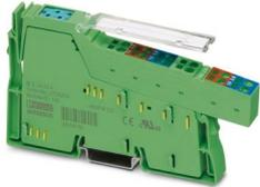
Inline, Morsetto ingresso digitale, Ingressi digitali: 4, 24 V DC, tecnica di connessione: 3 conduttori, Variante per condizioni estreme:, velocità di trasmissione nel bus locale: 500 kBit/s, grado di protezione: IP20, connettore Inline e cartellini di siglatura incl.
