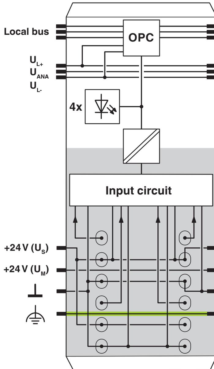
Circuito interno dei punti di connessione
