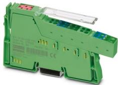
Inline, Morsetto uscita digitale, Uscite digitali: 4, 24 V DC, tecnica di connessione: 3 conduttori, velocità di trasmissione nel bus locale: 500 kBit/s, grado di protezione: IP20, connettore Inline e cartellini di siglatura incl.
