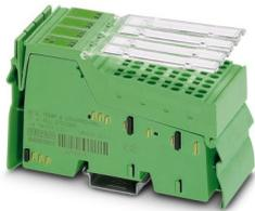
Modulo d'ingresso analogico Inline, completo di accessori (connettori e cartellini di siglatura), 8 canali, TC (termocoppia), RTD (sensore resistenza), connessione a 2, 3 conduttori
