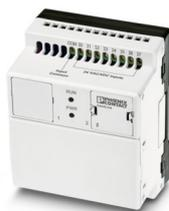
24 V DC, unità di base Nanoline. Dotato di 8 ingressi digitali, 2 ingressi analogici (0-10 V) e 4 canali di uscita relè. È possibile aggiungere canali I/O e applicare fino a 3 moduli di espansione I/O. I moduli di comunicazione opzionali consentono una connessione di rete o una connessione seriale. Un dispositivo di gestione opzionale mette a disposizione un'interfaccia utente. La programmazione avviene mediante nanoNavigator.
